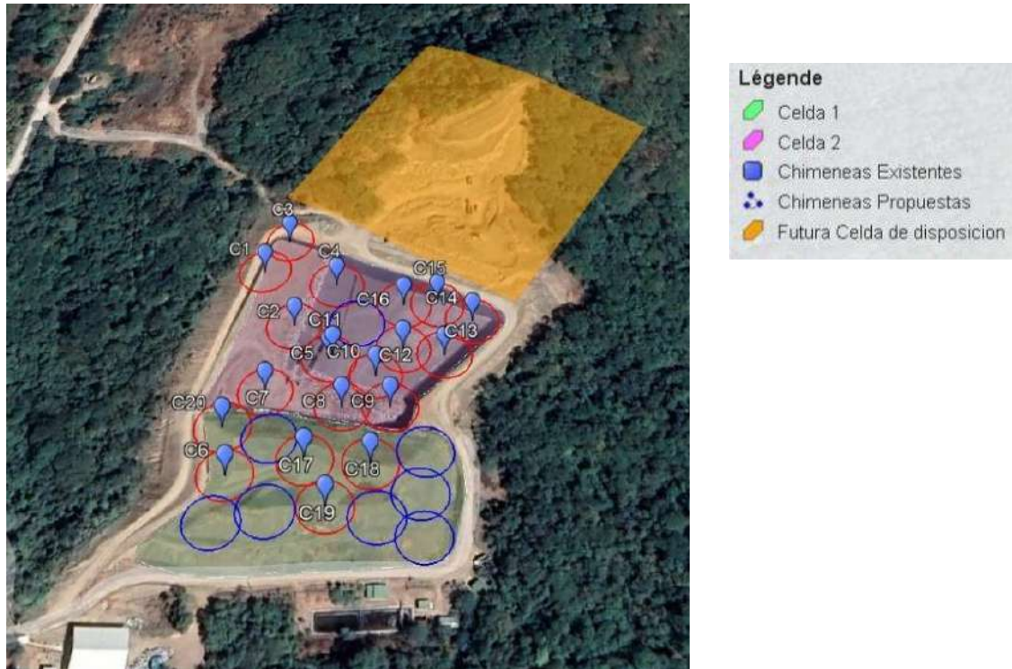
Imagen 23. Propuesta del sistema de chimeneas para la captura de biogás en R2
