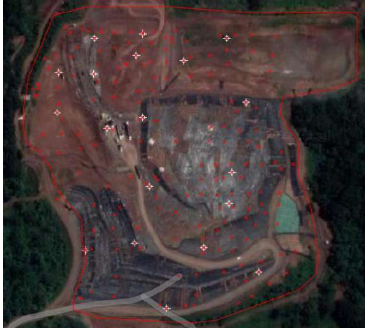
Imagen 19. Distribución de chimeneas existentes en R1 (Fuente: DWG proporcionado por el relleno sanitario)
