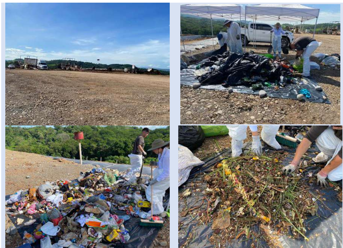
Imagen 9. R1, julio 2023. Se aprecia el cuarteo de las muestras y la fracción de residuos orgánicos obtenida al final del proceso.
