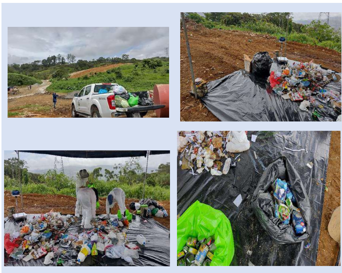
Imagen 13. Imágenes del V1, julio 2023. Se visualiza la recepción de muestras, cuarteo y separación de tipo de residuos.
